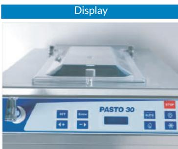
Il microcomputer digitale è di semplice utilizzo e indica le varie fasi del processo di pastorizzazione: riscaldamento e raffreddamento.
